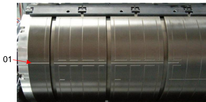
图6-2 版材边缘检测 U 槽
