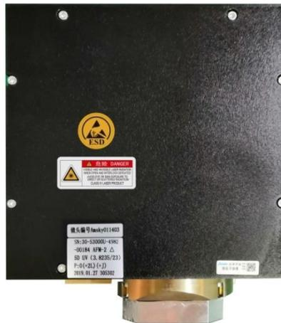
图2-2 光学平台上的激光标签及位置
